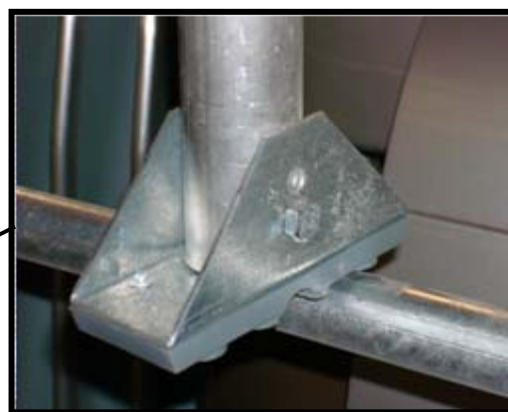
Patin de support pour éviter le basculement de l'escabeau
