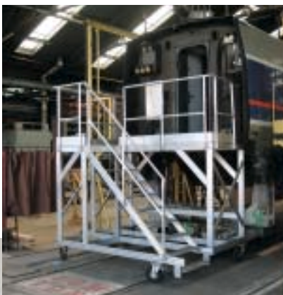
Accès arrière rame TGV.
