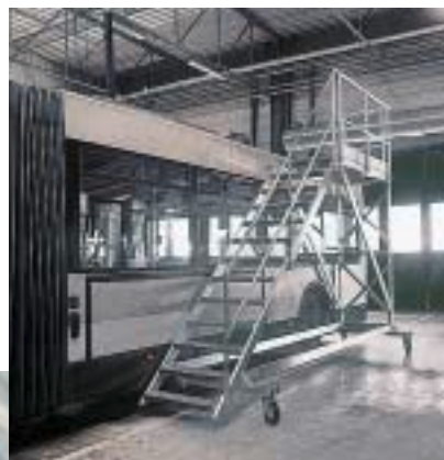
Escabeau d'accès toiture bus.
