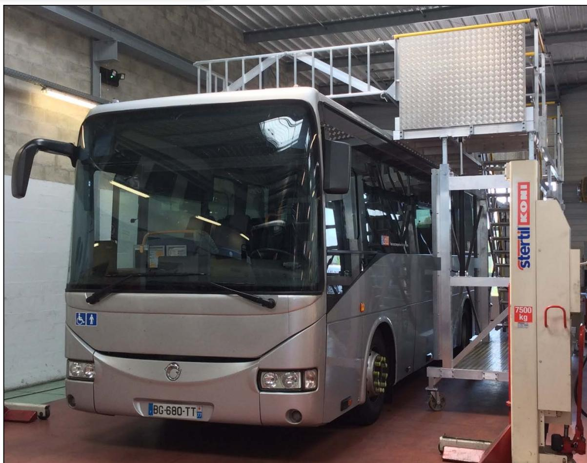
Plate forme mobile en aluminium brut en situation – hauteur de plancher réglable de 2,90 à 3,90 mètres.
