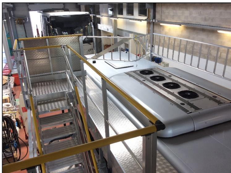
Le déploiement du garde corps articulé permet la mise en sécurité des opérateurs en toiture du bus.
