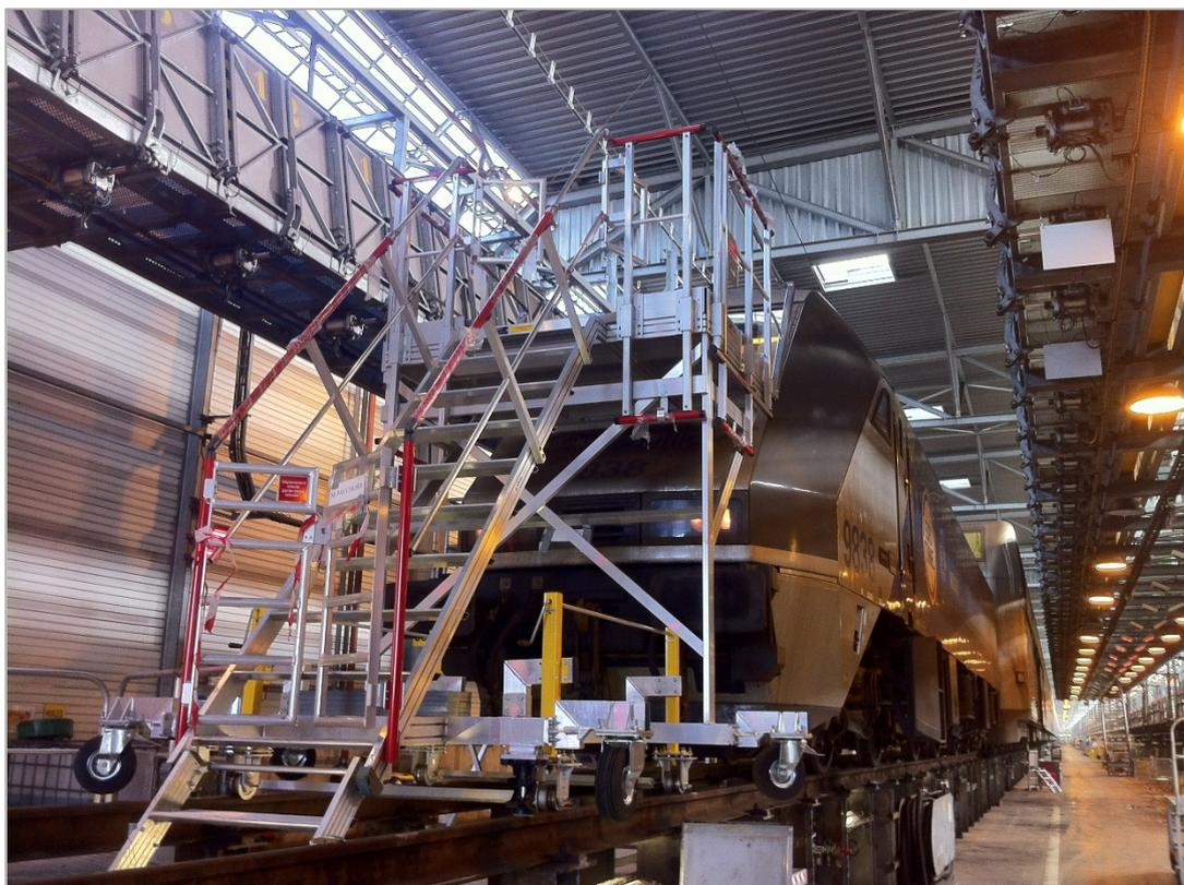
Structure principale en profils aluminium brut extrudé de section 100 x 30 mm et 100 x 100 mm composé :
