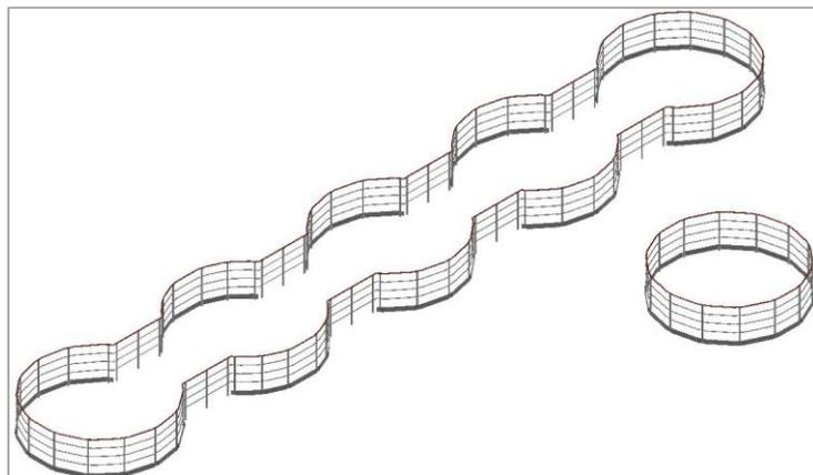
Le haut des cuves existantes pour stockage des farines est sécurisé par la pose de garde-corps sur une périphérie totale de 63 mètres.
