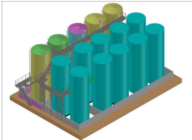
Implantation 3D des escaliers et passerelles sur le groupe de silos inox « stockage graisses »
