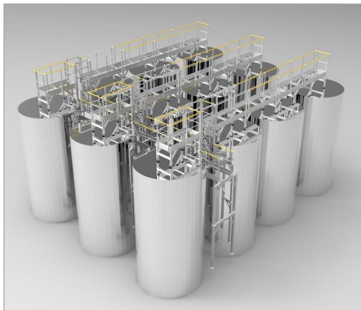
Vue 3D de la mise en place des passerelles sur les cuves inox
