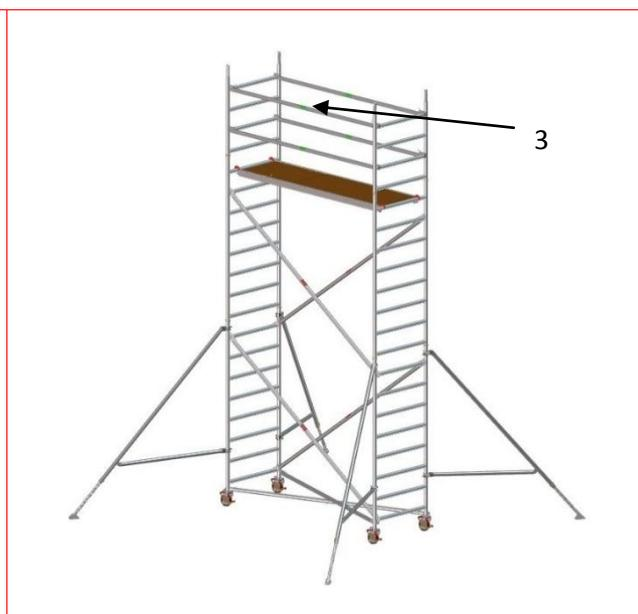
**6.** Accrocher les lisses de protection (rep.3) au niveau du plancher trappe et de(s) palier(s) de repos intermédiaire(s)
