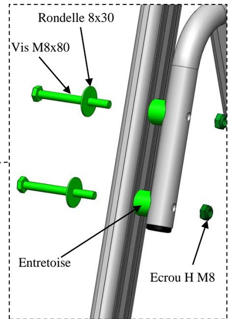
**2. Assembler le garde corps (Rep2) inférieur à l'aide des boulons M8 disponibles sur la structure.**
