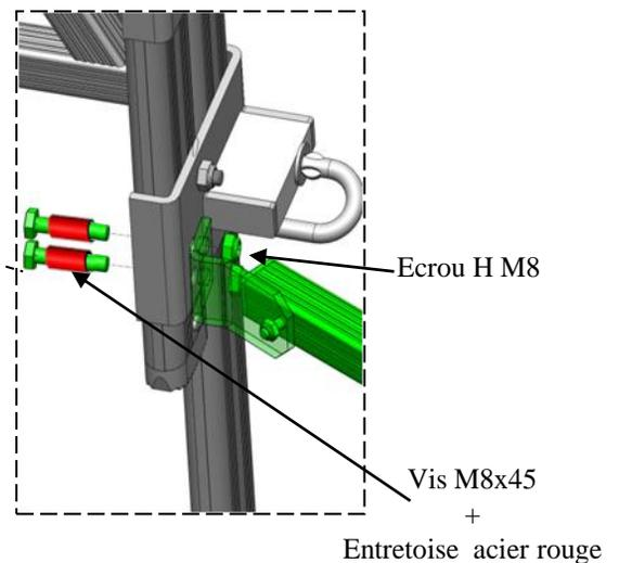
**3. Fixer les stabilisateurs (Rep3) avec la visserie M8 pré-montée sur la structure.**
