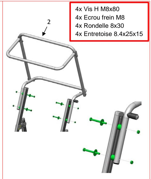
**1.** Déployer la structure (Rep1) et boulonner le garde-corps supérieur (Rep2) (voir 1.a) puis boulonner le garde-corps inférieur (rep3) (voir 1.b) à l'aide des boulons M8 disponibles sur la structure
