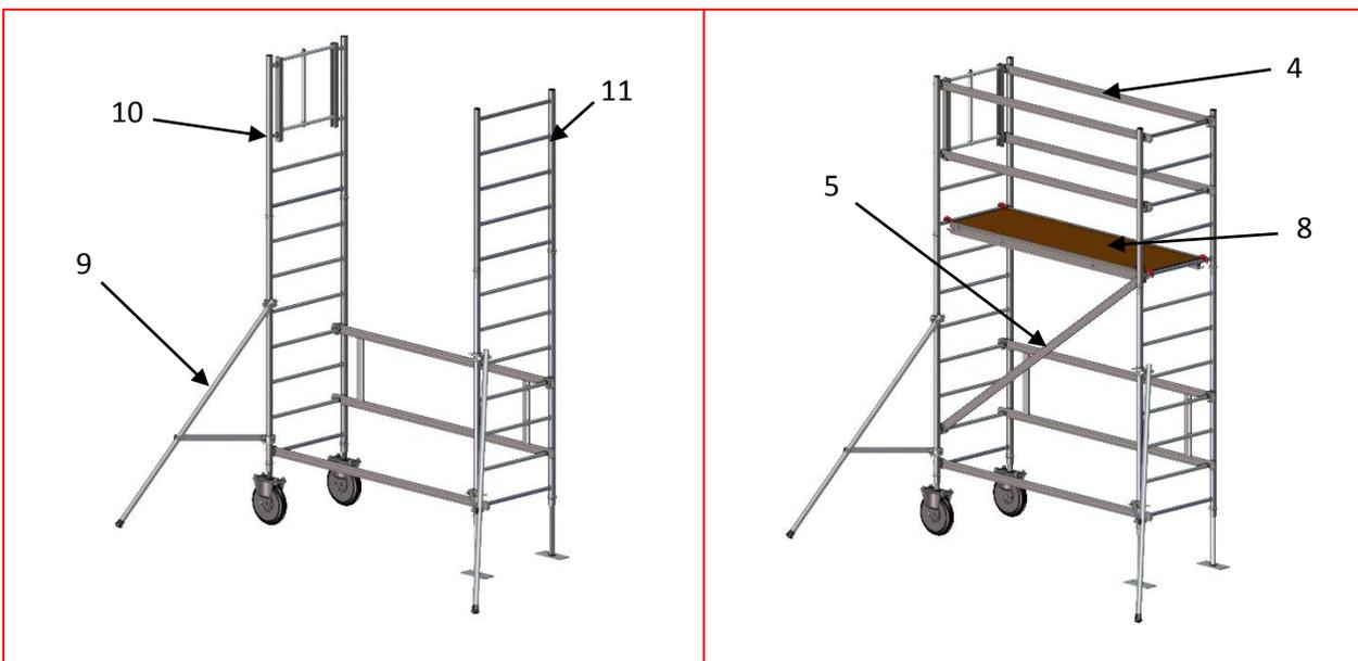
**3.** Positionner les stabilisateurs (rep.9). Positionner l'échelle verticale ouverte + portillon 1200x720 (rep.10) et l'échelle verticale 1200x720 (rep.11). Goupiller les éléments au fur et à mesure de leur montage avec les goupilles (rep.1).
