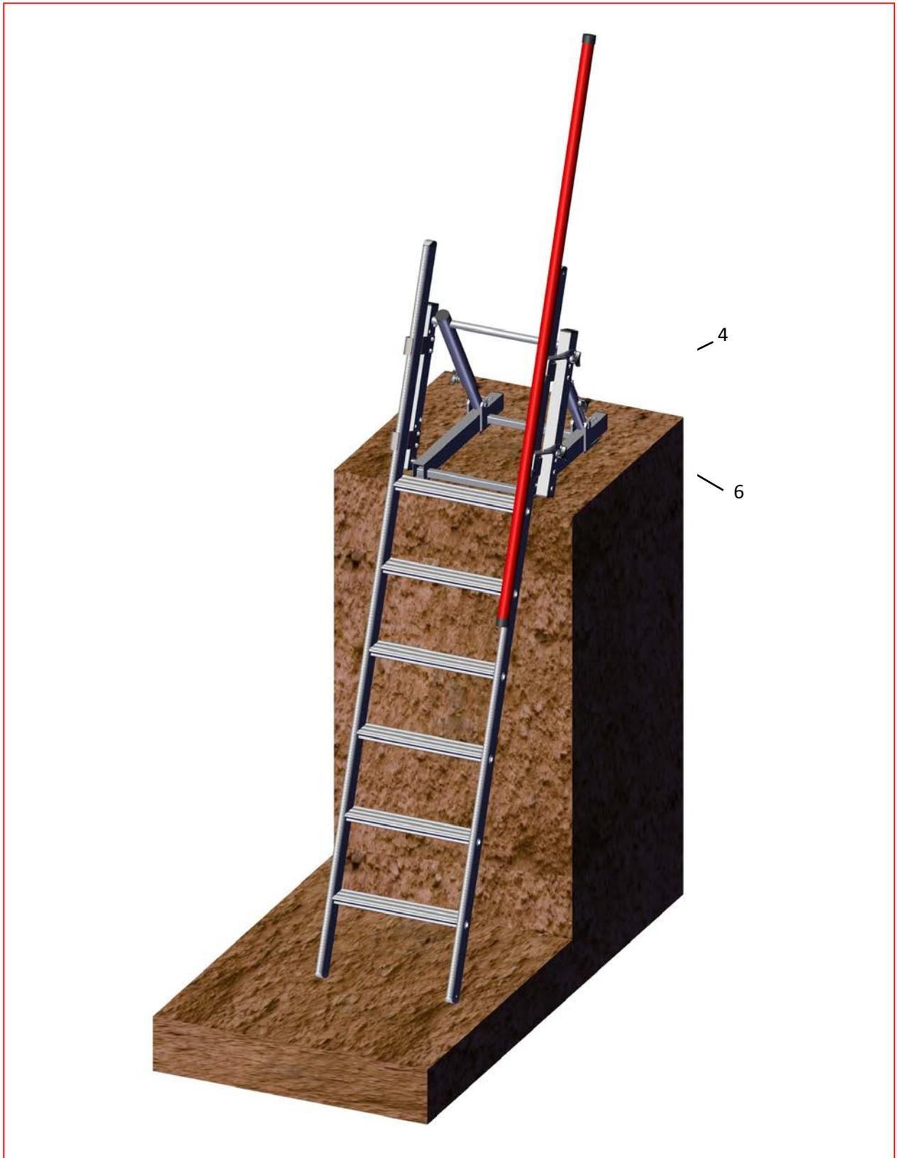
**5.** Une fois tous les éléments assemblés, assurez-vous du réglage de l'angle à l'aide des deux vis trio (Rep.4) présentes sur le triangle réglable (Rep.1). L'angle doit être réglé de manière à ce que le plan des marches soit à l'horizontale. Puis régler les patins réglables (Rep.6) afin de compenser les différences de niveaux du sol pour garantir la stabilité de l'ensemble.
