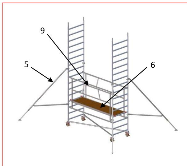
**3.** Installer les stabilisateurs (rep.5) sur deux échelles différentes puis le second cadre (rep.9) sur le 3ème échelon puis pré-positionner le plancher à trappe (rep.6) au quatrième échelon en partant du bas.
