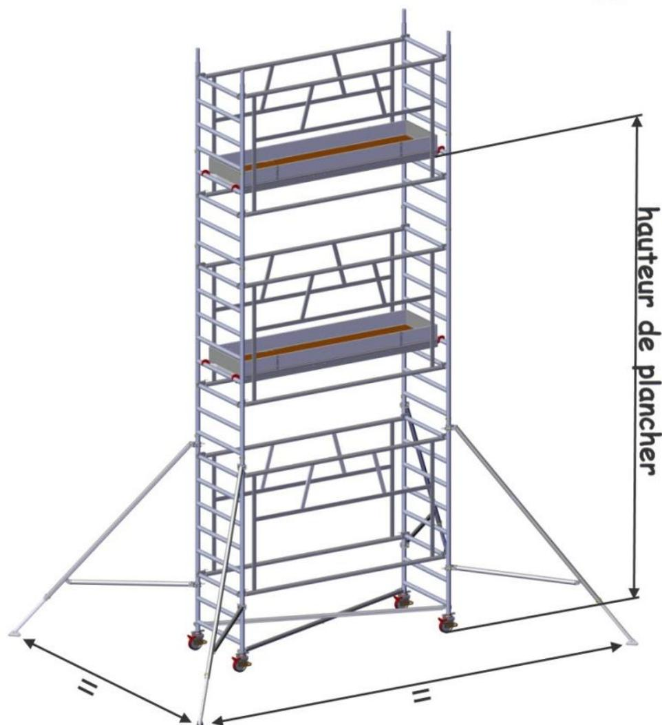
**8.** Contrôler le calage de l'échafaudage roulant en vérifiant que les stabilisateurs (rep.5) soient à égale distance dans le sens latéral et longitudinal. S'assurer du verrouillage correct des cadres.
