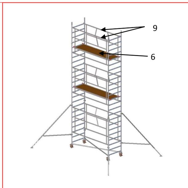
**6.** Installer les cadres supérieurs (rep.9) puis positionner le 1<sup>er</sup> plancher à trappe (rep.6) dans sa position finale.
