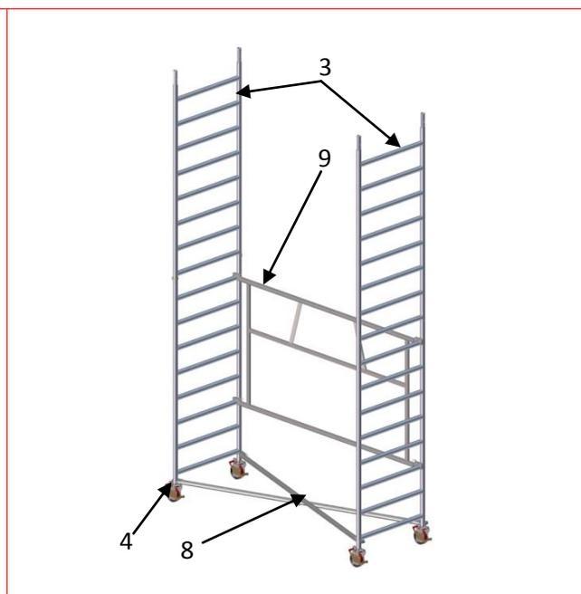
**2.** Pour assurer l'équerrage en plan et rigidifier la structure, installer le cadre (rep.9) sur le 3ème échelon puis positionner la croix de Saint-André (rep.8) Vérifier les aplombs et les niveaux horizontaux et verticaux par le réglage des vérins (rep.4) puis installer les échelles verticales supérieures (rep.3) et les goupiller.
