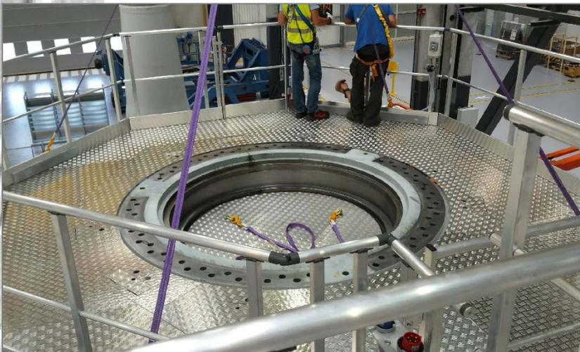
Plate forme avec revêtement en tôle alu larmée – protection caoutchouc autour de la découpe – garde-corps avec 2 portillons de sécurité diamétralement opposés – installation de prises électriques et de branchement à air comprimé.
