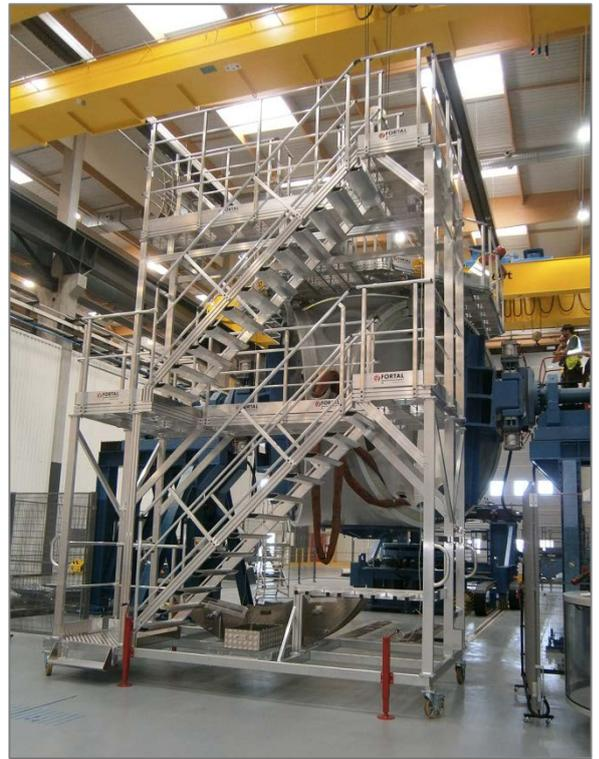
Tour d'accès avec escalier largeur 800 mm – marches alu striées antidérapantes prof. 230 mm – garde-corps avec lisse, sous lisse et plinthe – béquilles d'immobilisation – roues à frein Ø 200 mm.
