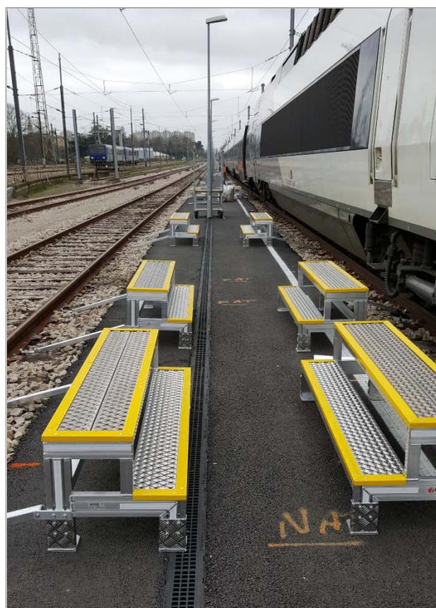
Marchepieds en place sur les quais – fixation sur les rails à l'aide des kits de fixation fournis (paire).
