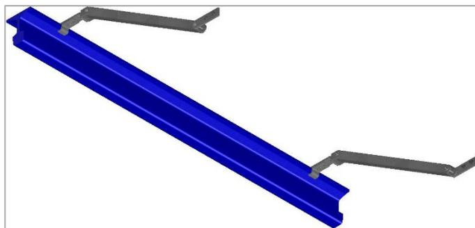
Vue 3D du principe de fixation sur les rails
