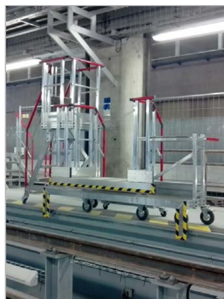
Principe du guidage par rail de l'ensemble sur le bord de la fosse
