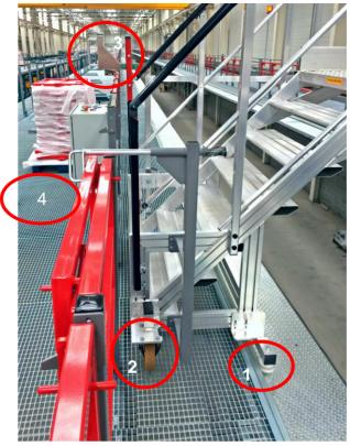
Vue sur système de guidage par galet (1) et sur système de levier à roulettes type « homme mort » (2)
