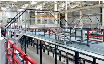
Hauteur sous passerelle : 1 280 mm Longueur de passage dessous du palier : 2 300 mm
