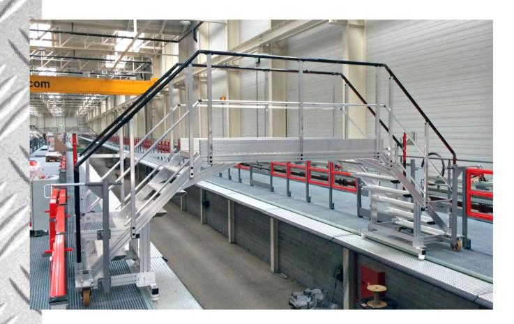
Ponton mobile – en profil aluminium brut extrudé de section 110 x 35 mm permettant le passage d'une structure à une autre – au-dessus des voies, en l'absence de rame. Charge admissible maxi. 2 personnes + 70 kg de matériel
