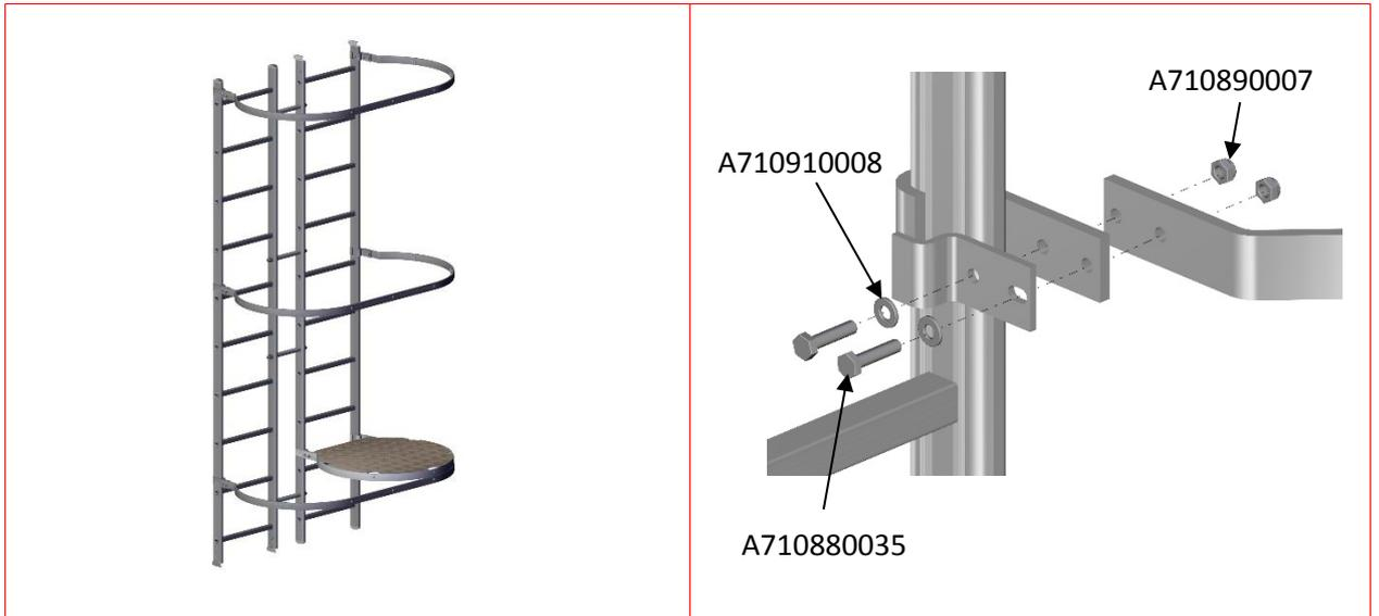
**3.** Fixer le palier de repos : il doit reposer sur l'arceau du bas.
