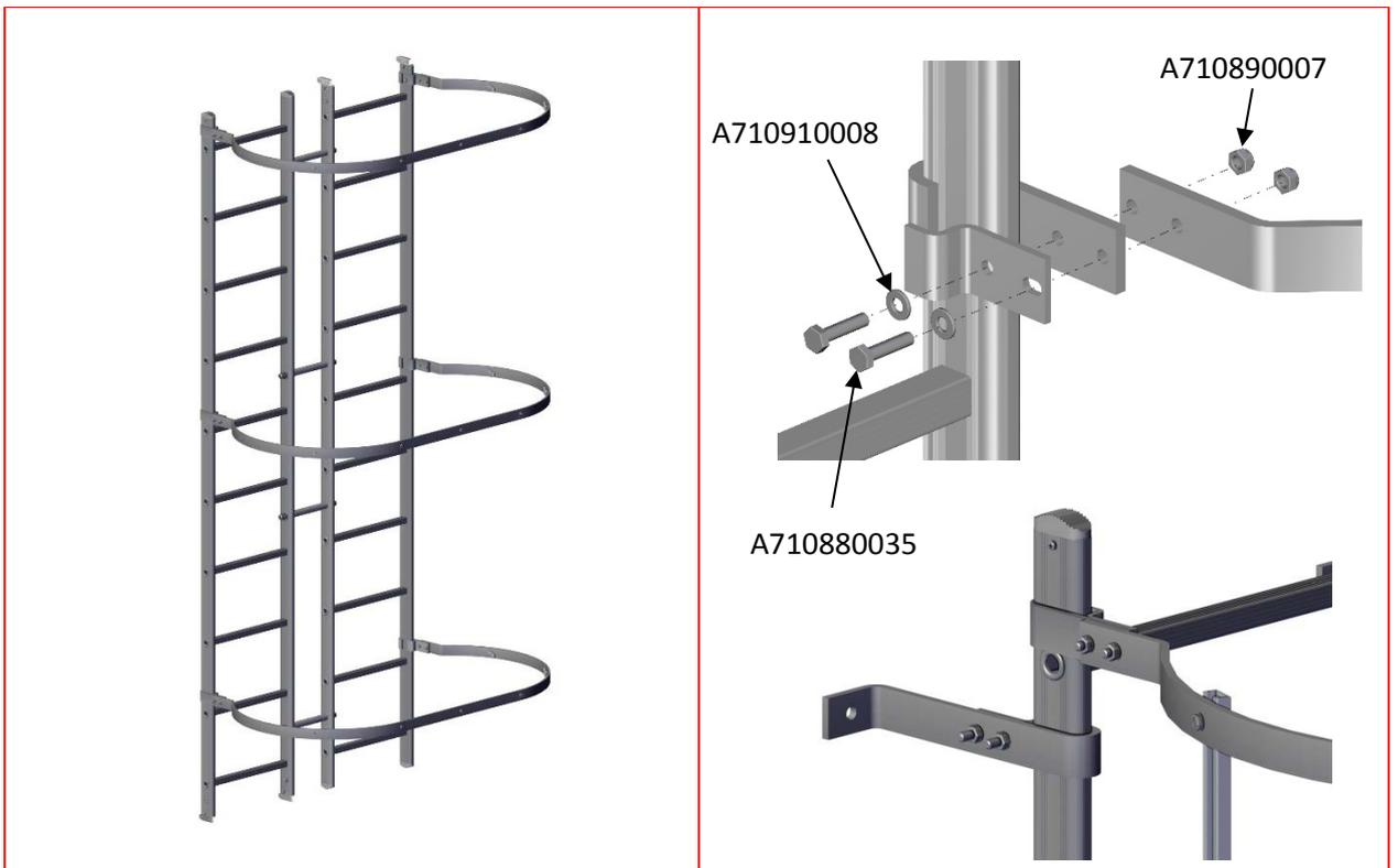
**2.** Fixer les arceaux en les plaçant en butée contre les sertissages des barreaux.
