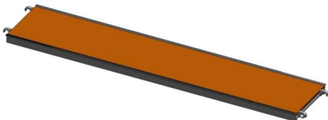
**b) Plancher trappe :** Le plancher est constitué d'une ossature en aluminium et d'un platelage de type bois antidérapant (épaisseur 9 mm, 7 plis) interchangeable.
