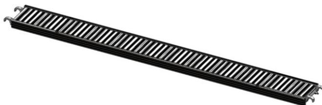
**g) Plancher d'angle:** Le plancher est constitué d'une ossature en aluminium et d'un platelage en aluminium, s'utilise en fermeture des extrémités de structures d'échafaudages. Il ferme dans les angles les espaces vides entre l'échafaudage et l'édifice de forme plus ou moins circulaire. Il se fixe sur les traverses par 4 crochets en ALU. Il est équipé de tiges anti soulèvement et anti basculement.
