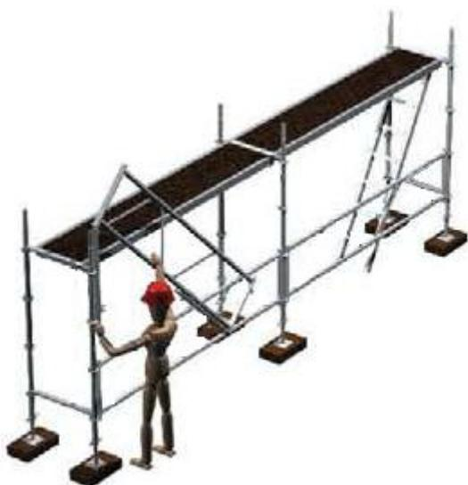
6 Accrochage du 1<sup>er</sup> bras articulé du garde-corps de montage et d'exploitation repliable dans les rosaces.
