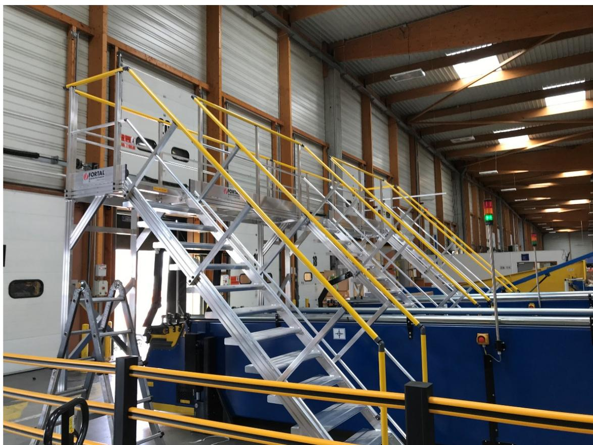
Plateforme triple accès dans un centre de distribution de colis en profils aluminium brut extrudé 100 x 30 mm
