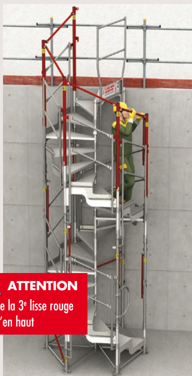
> 11 - Pose de 5 poteaux rouges de fermeture ⑤. En redescendant, mise en place de toutes les 3 e lisses rouges (sauf entrées) et du garde-corps d'entrée B. ⑥.
