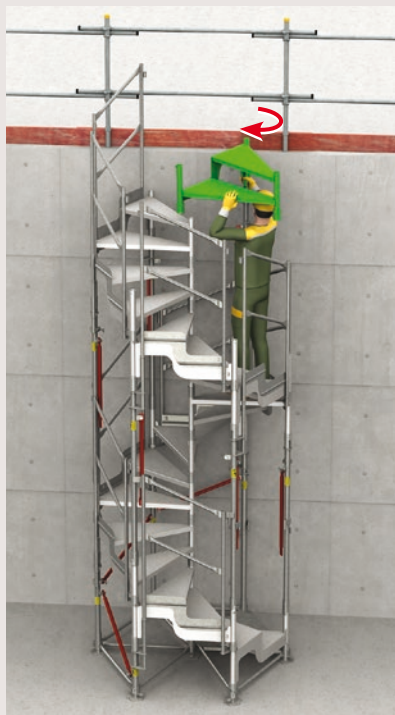
> 9 - Pose d'un module 2 marches ③.
