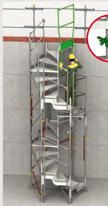
> 10 - Pose du garde-corps de fermeture ④. Serrer fermement les 2 colliers.
