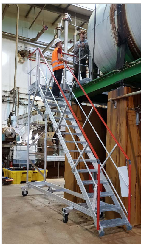
Escalier mobile d'accès – largeur utile : 600 mm – marches caillebotis de prof. 280 mm – 4 roues pivot à frein pour un déplacement facilité. Cet escalier est déplacé régulièrement pour permettre le passage de camions.
