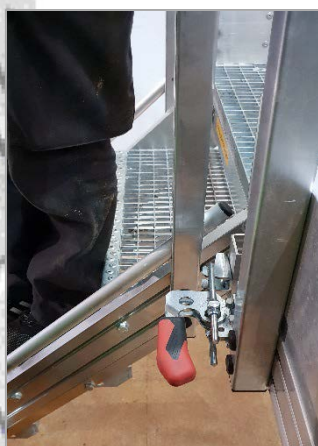
Fixation escalier d'accès sur palier par sauterelle
