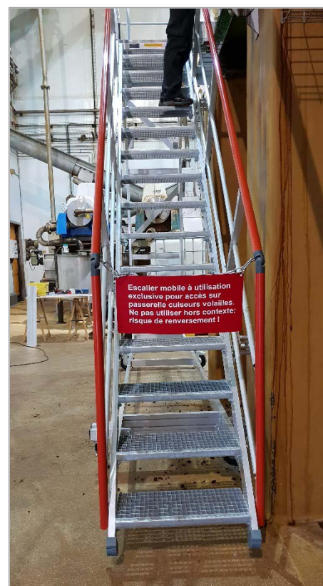
Escalier mobile d'accès – largeur utile : 600 mm – marches caillebotis de prof. 280 mm – 4 roues pivot à frein pour un déplacement facilité. Cet escalier est déplacé régulièrement pour permettre le passage de camions.
