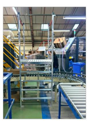
Escalier à palier en profils aluminium brut extrudé 100 x 30 mm :
