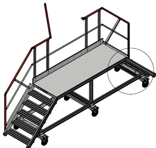
La main courante est relevable pour permettre la manutention aisée du climatiseur – verrouillage par clip tube avec élingue
