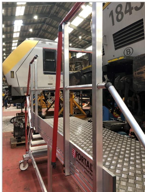
Passerelle mobile pour opération de recharge climatiseur :
