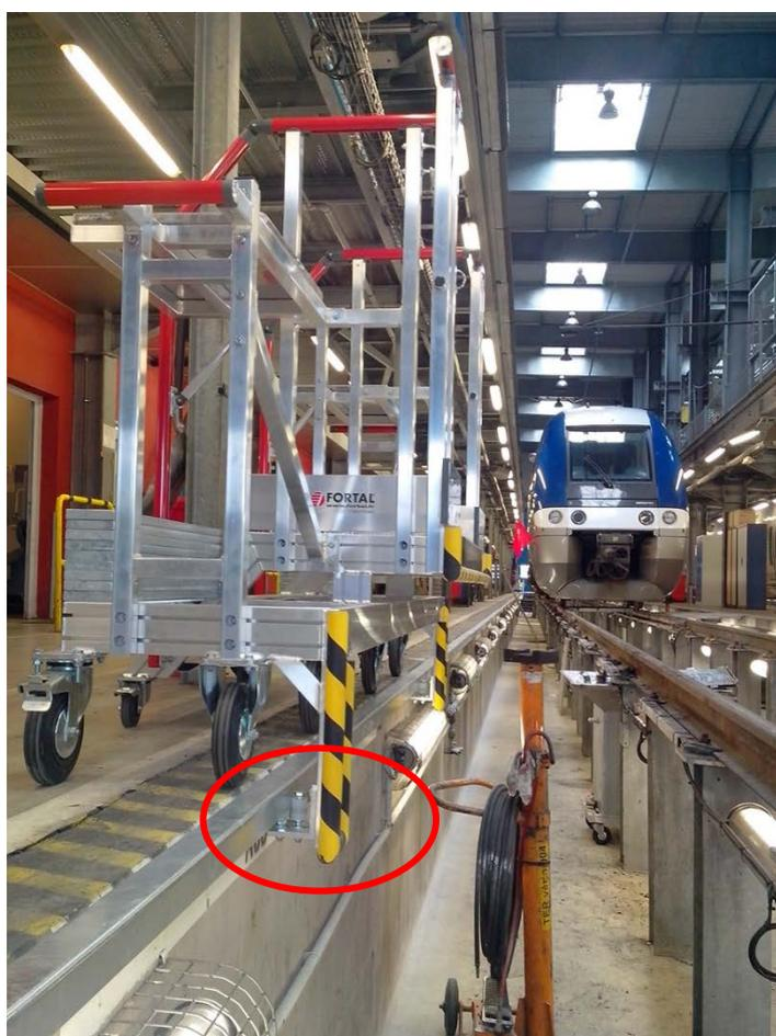
L'escabeau est utilisé en toute sécurité par guidage sur un rail (avec butée) d'une longueur de 80 mètres fixé au mur d'un côté de la fosse
