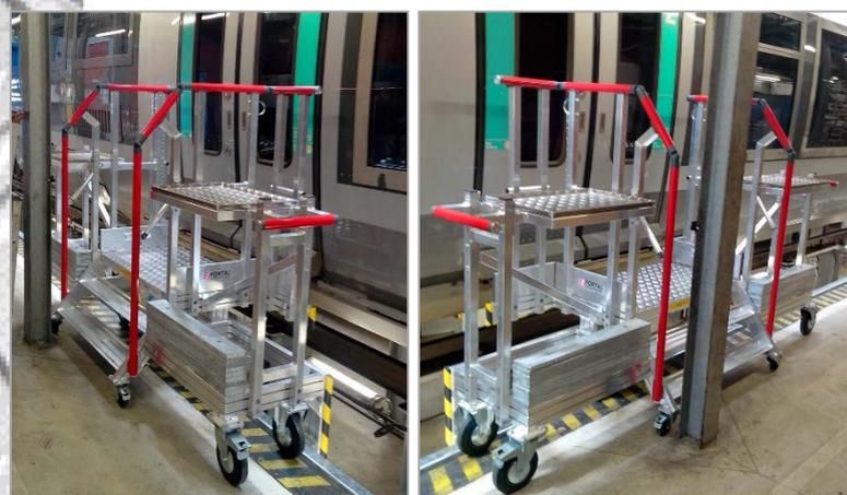
L'escabeau mobile trouve parfaitement sa place dans un encombrement restreint entre la fosse et les structures du bâtiment.
