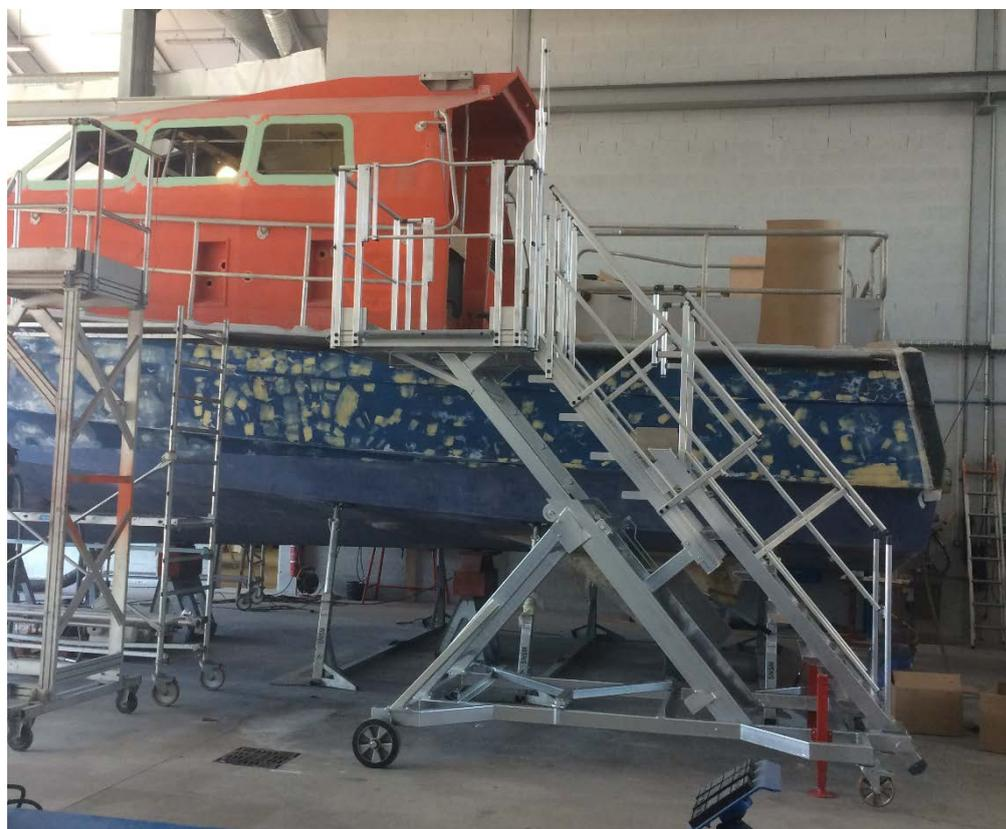
Escabeau mobile réglable en hauteur pour la maintenance des différents bateaux utilisés pour le sauvetage en mer.
