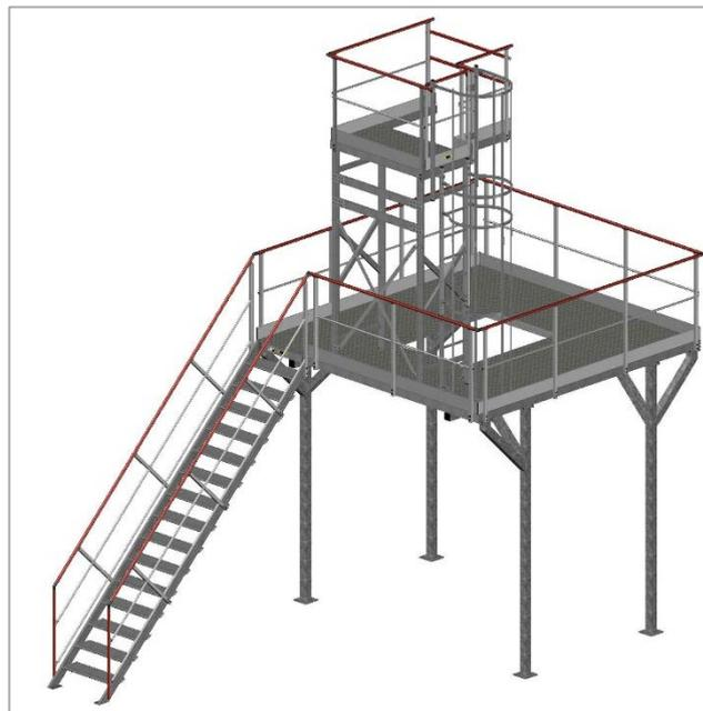
Structure en profils aluminium brut extrudé 110 x 35 mm à 2 passerelles et base de soutien en acier galvanisé
