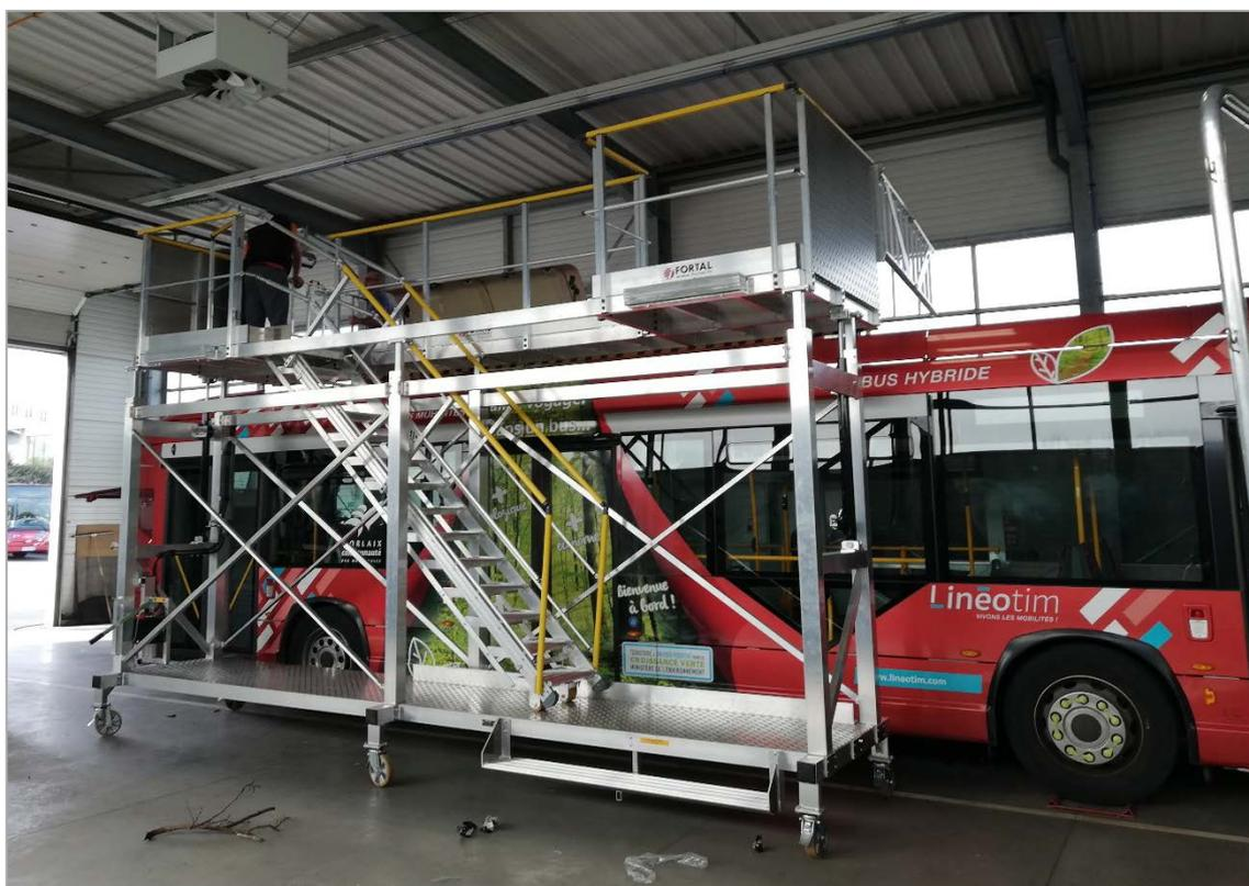
Plateforme mobile réglable en hauteur pour différents travaux de réparation et de maintenance en toiture de bus hybrides.
