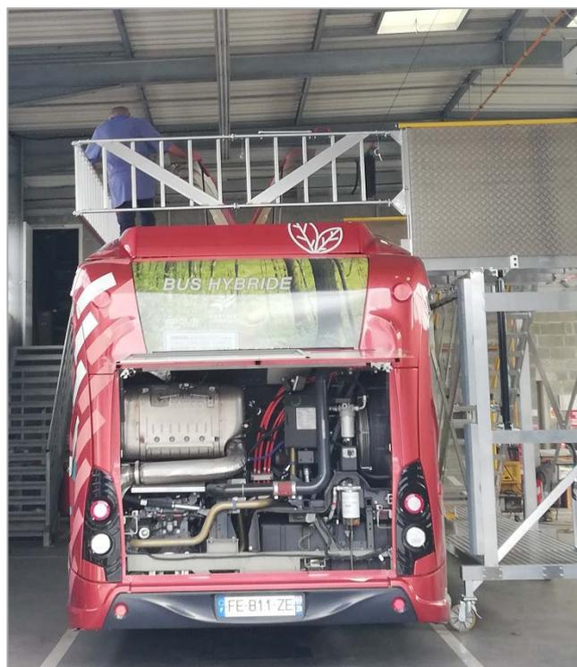
Enceinte de garde-corps hauteur 1 100 mm articulée et déployable sur 2 000 ou 2 550 mm sur la toiture du bus pour assurer une zone de travail sécurisée pour les personnels.
