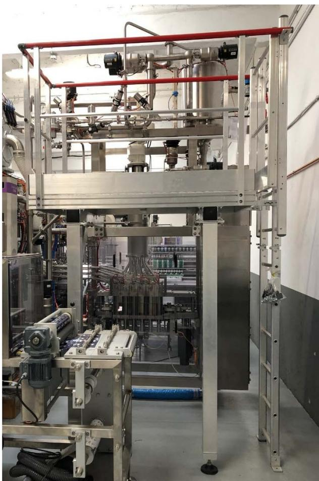
Structure principale en profils alu brut extrudé 100 x 30 mm
