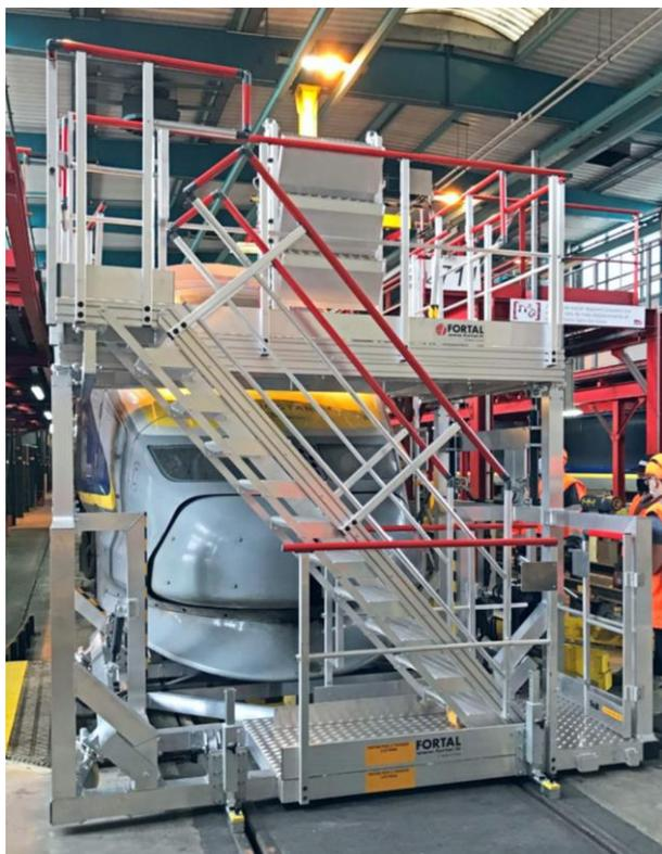
Praticable réglable en hauteur entre 2 315 et 2 815 mm par vérin hydraulique actionné par pompe à main.
