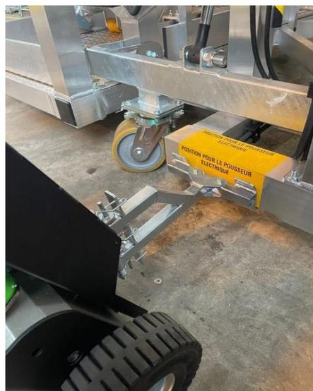
Option : pousseur électrique : 3 points de préhension visualisés par autocollant jaune : 1 frontal – 2 latéraux pour un déplacement facilité à 5 km/h maxi.
