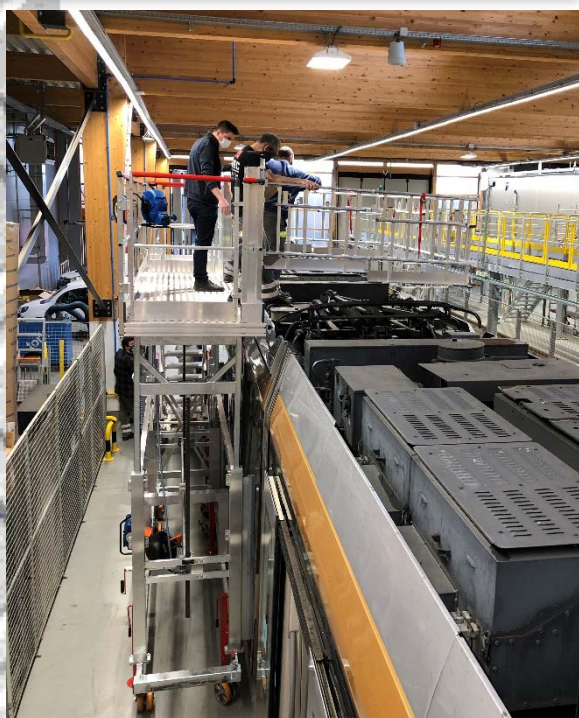
Réglage en hauteur entre 2 800 et 3 815 mm par treuil à crémaillère
