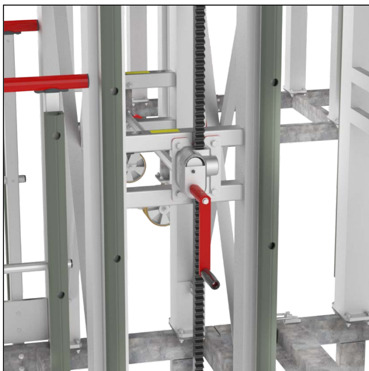
Réglage en hauteur entre 2 800 et 3 815 mm par treuil à crémaillère
