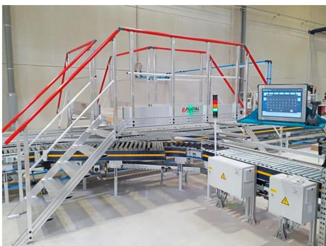
Escalier triple accès pour franchissement de convoyeur en profil aluminium brut extrudé section 100x30 mm.
