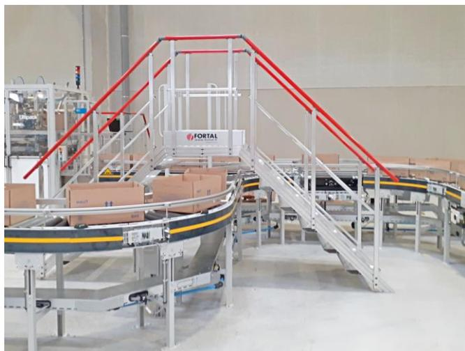
Escalier double accès pour franchissement de convoyeur en profil aluminium brut extrudé section 100x30 mm.
