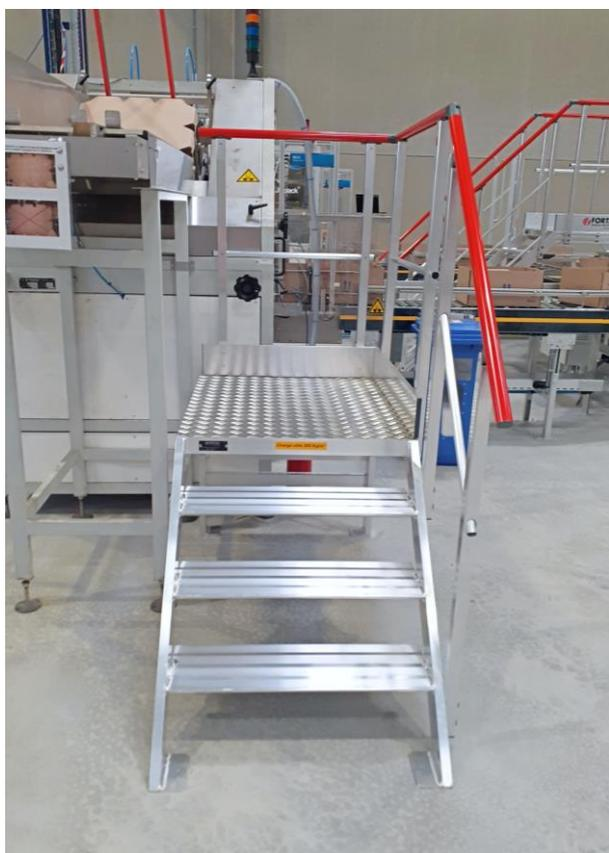
Plateforme de travail en profil aluminium brut extrudé section 100x30 mm.
