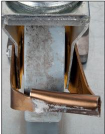
Distorsion du pédalier résultant d'un impact important ; il est probable que la plaque supérieure et le support soient également déformés.
