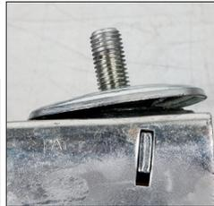
Distorsion de la plaque de montage résultant d'un seul impact important ou de plusieurs impacts au niveau inférieur. **Même si le reste de la roulette est en bon état, elle devra toutefois être remplacée.**
