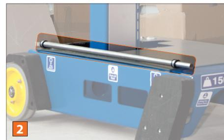
L'outil d'abaissement d'urgence sur troue sur le châssis.
