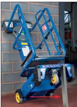
Veillez à utiliser un étançon de sécurité de 660 mm de long que vous allez placer sous l'angle du châssis par l'un ou l'autre coussinet en caoutchouc afin d'empêcher la machine de basculer ; c'est ce qu'indique la flèche rouge.
