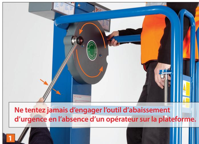
Tournez la roue dans le sens inverse des aiguilles d'une montre pour rabaisser la plateforme.
