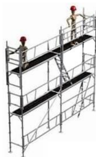
11 - Mise en place des garde-corps standard (longitudinale et d'extrémité) sur tout le niveau N
