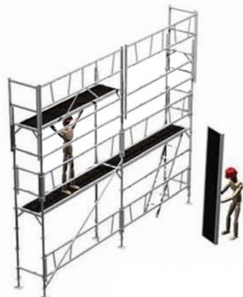
8 - Mise en place des garde-corps standard pour le niveau N
