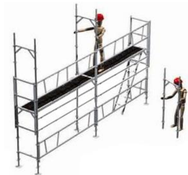
8 - Mise en place des garde-corps standard pour le niveau N
