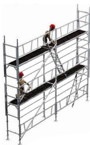
12 - Mise en place des diagonales verticales de contreventement (1 maille sur 5) voir chapitre 11 du présent document Mise en place des plinthes longitudinales et d'extrémités
