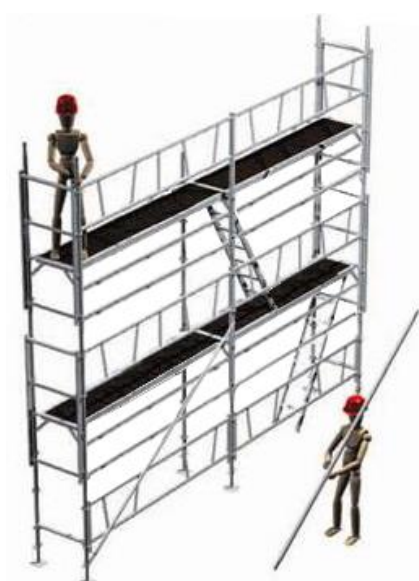
12 - Mise en place des diagonales verticales de contreventement (1 maille sur 5) voir chapitre 11 du présent document Mise en place des plinthes longitudinales et d'extrémités
