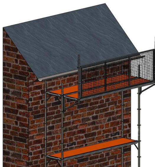
Possibilité de mettre des filets de protection : S'assurer que les filets ont été confectionnés dans des nappes ayant fait l'objet d'un classement selon la norme NF EN 1263-1 : « Filets de sécurité - Partie 1 : exigences de sécurité »
