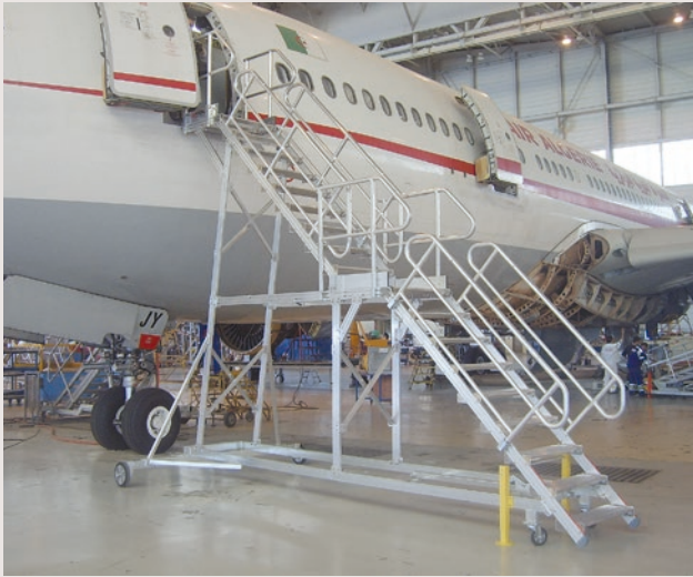
Escabeau d'accès technique tractable avec palier intermédiaire
