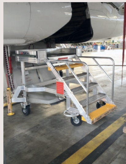
Escabeau pour accès puits de train d'atterrissage
