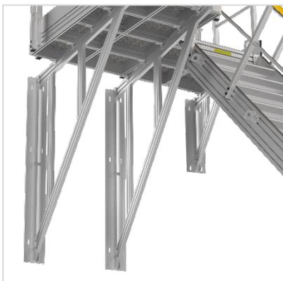
Le palier repose sur des consoles réglables en aluminium afin de s'adapter à la surface du mur support. Dans le cas présent le mur est voûté.
