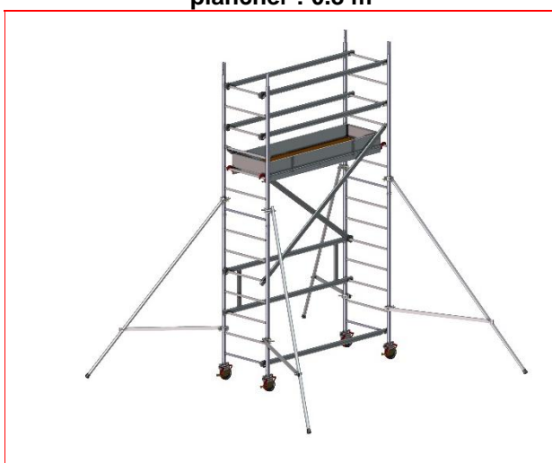
Echafaudage de type ERIS 110, hauteur de plancher : 2.60 m
