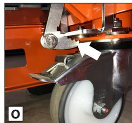
6. Assurez-vous que les portes d'entrée de la plateforme s'ouvrent et se ferment librement et se referment automatiquement lorsqu'elles sont relâchées. Vérifiez si les pivots et les ressorts ne présentent pas de signes d'usure ou de détérioration.
