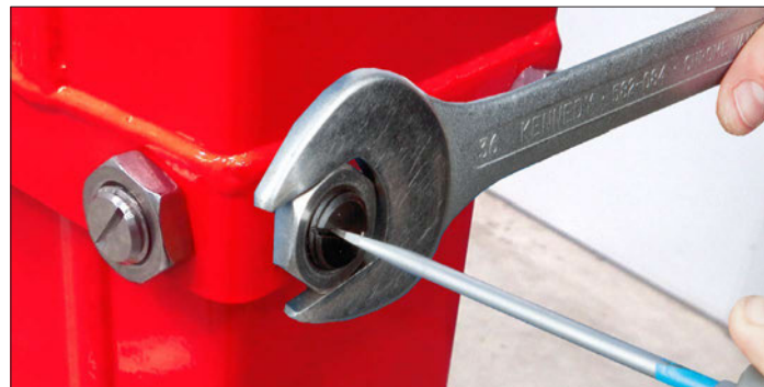
Réglage de la vis d'usure du mât
