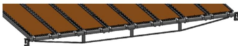
Exemple d'une lisse renforcée 2950 servant de support pour 8 planchers Sécubloc largeur 345 mm
