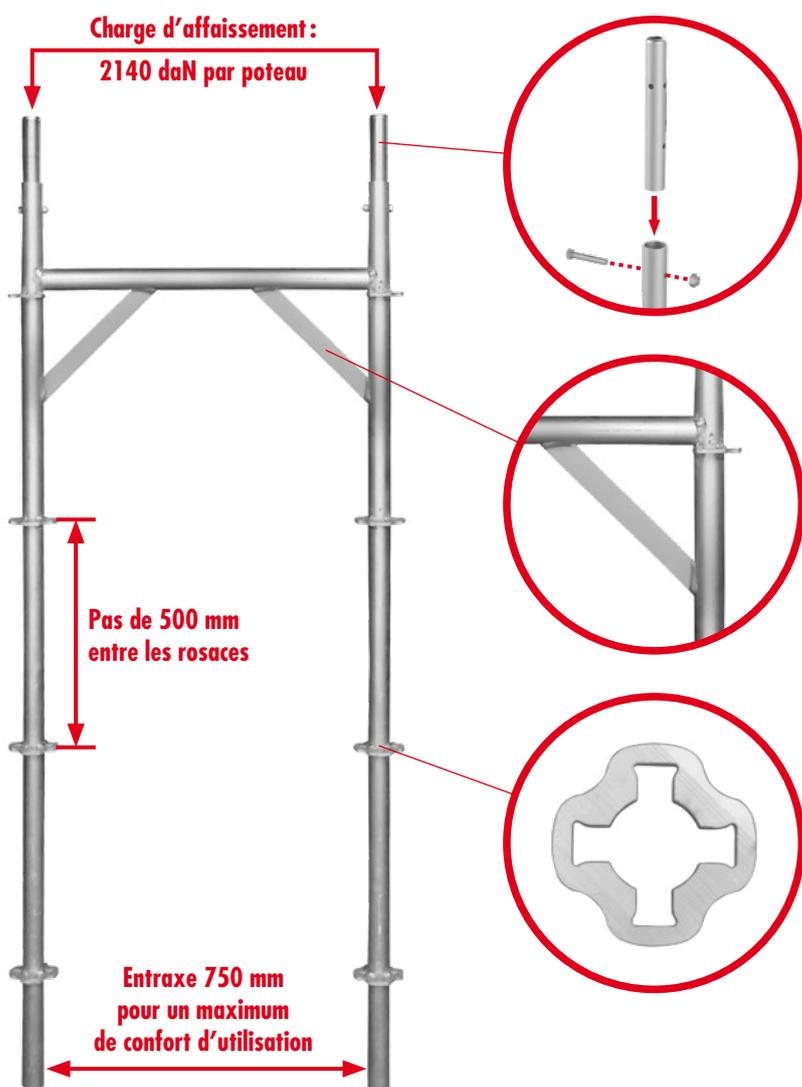
**Manchons en acier galvanisé vissés :** facilitent la mise en place des portiques et garantissent la durabilité de leur emboîtement. Les manchons sont démontables (par exemple pour le passage sous les gouttières) et peuvent facilement être remplacés, si nécessaire.
