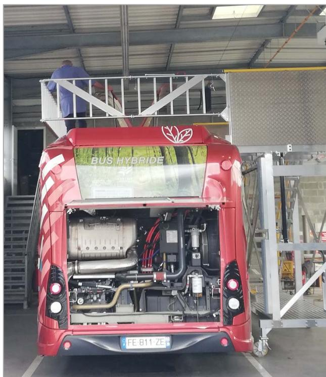
Ausfahrbares Geländer, mit einer Höhe von 1 100 mm, gelenkig, über 2 000 oder 2 550 mm auf dem Busdach ausfahrbar, um einen sicheren Arbeitsbereich für das Personal zu gewährleisten.
