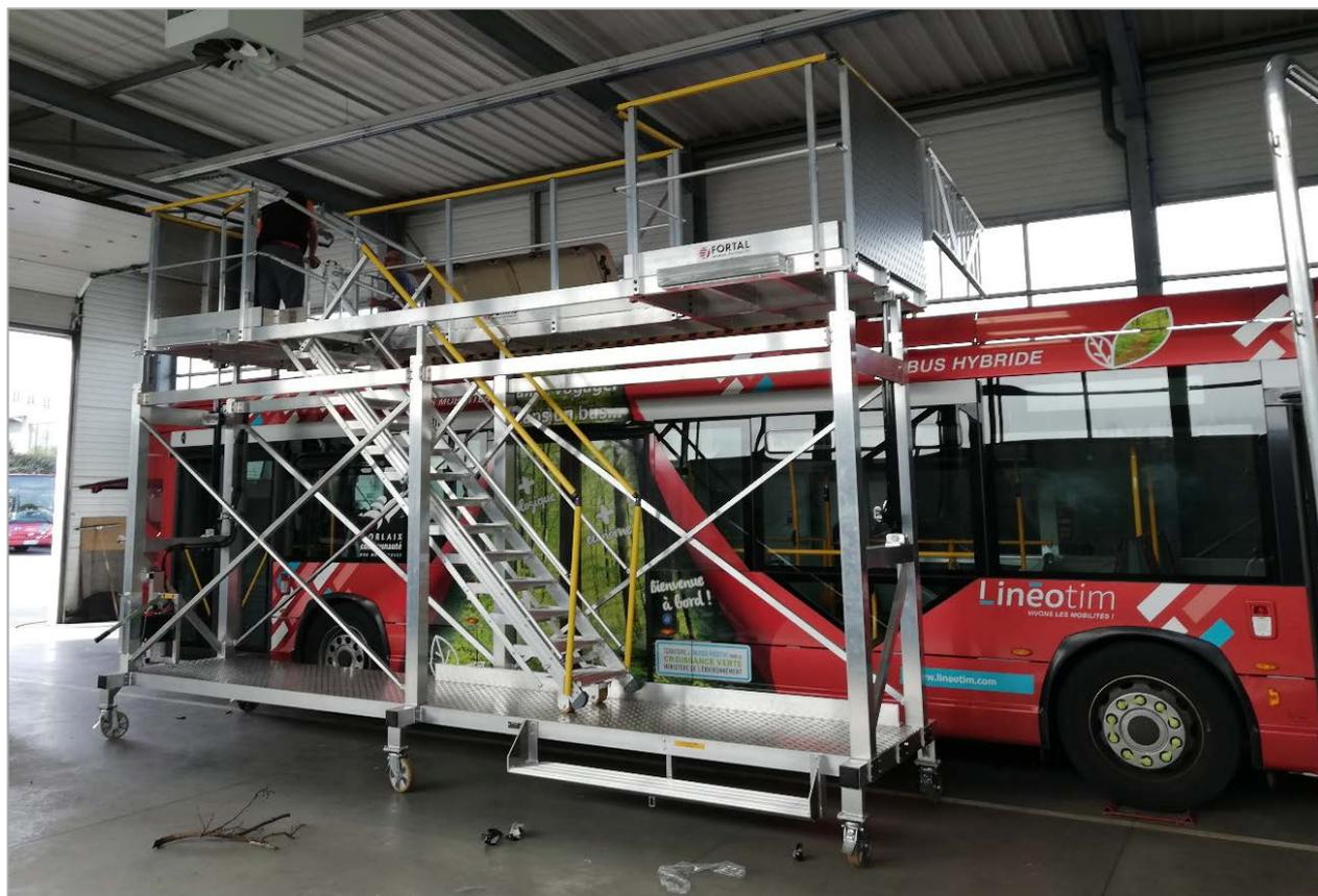
Höhenverstellbare mobile Plattform für verschiedene Reparatur- und Wartungsarbeiten an Hybridbusdächern. Tragstruktur aus verzinktem Stahl, Plattform aus Aluminium-Stranggussprofile. Zugang über eine Treppe mit variablem Höhenwinkel von 2 900 bis 3 900 mm über Hydraulikzylinder der mit einer Handpumpe vom Boden aus betätigt wird. Max. Belastung : 200 kg oder 2 Personen + Material.
