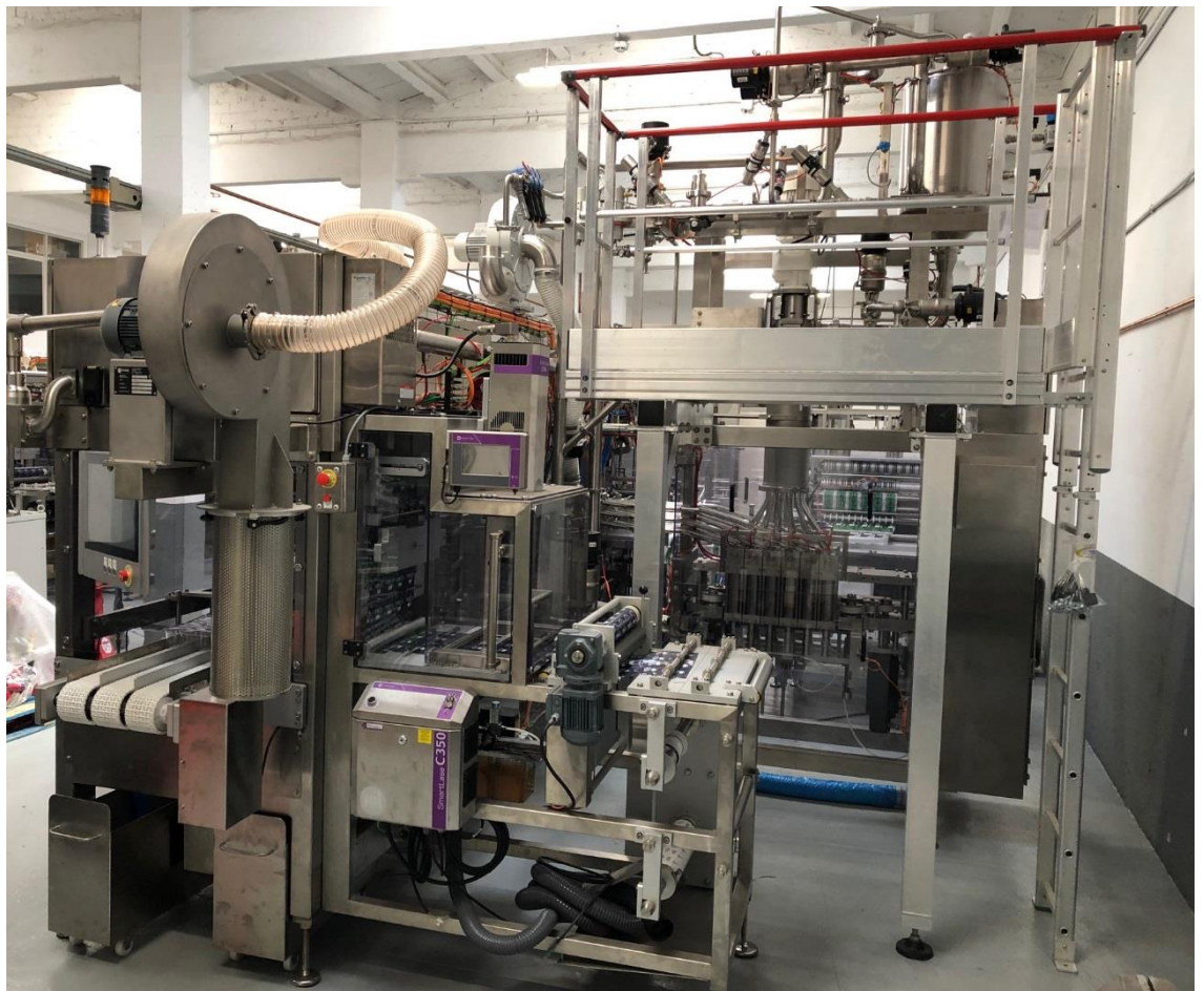
Aluminiumplattform für eine Joghurtverpackungslinie. Belastung : 200 kg/m 2 .
