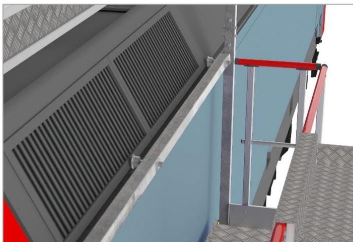
4 Gummirollen zum Schutz der Lackierung der Wagen vor Beschädigungen.
