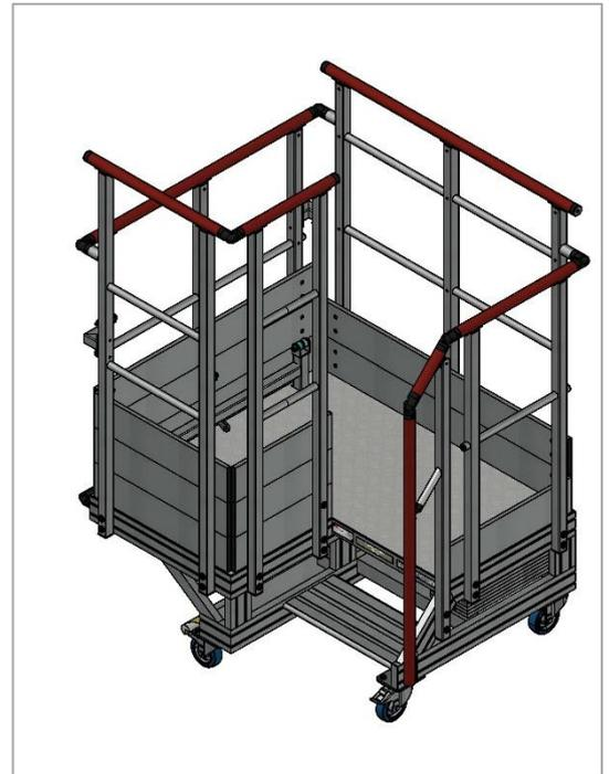
Fahrbare Plattform aus stranggepressten Rohaluminiumprofilen für eine Kühlermontagelinie
