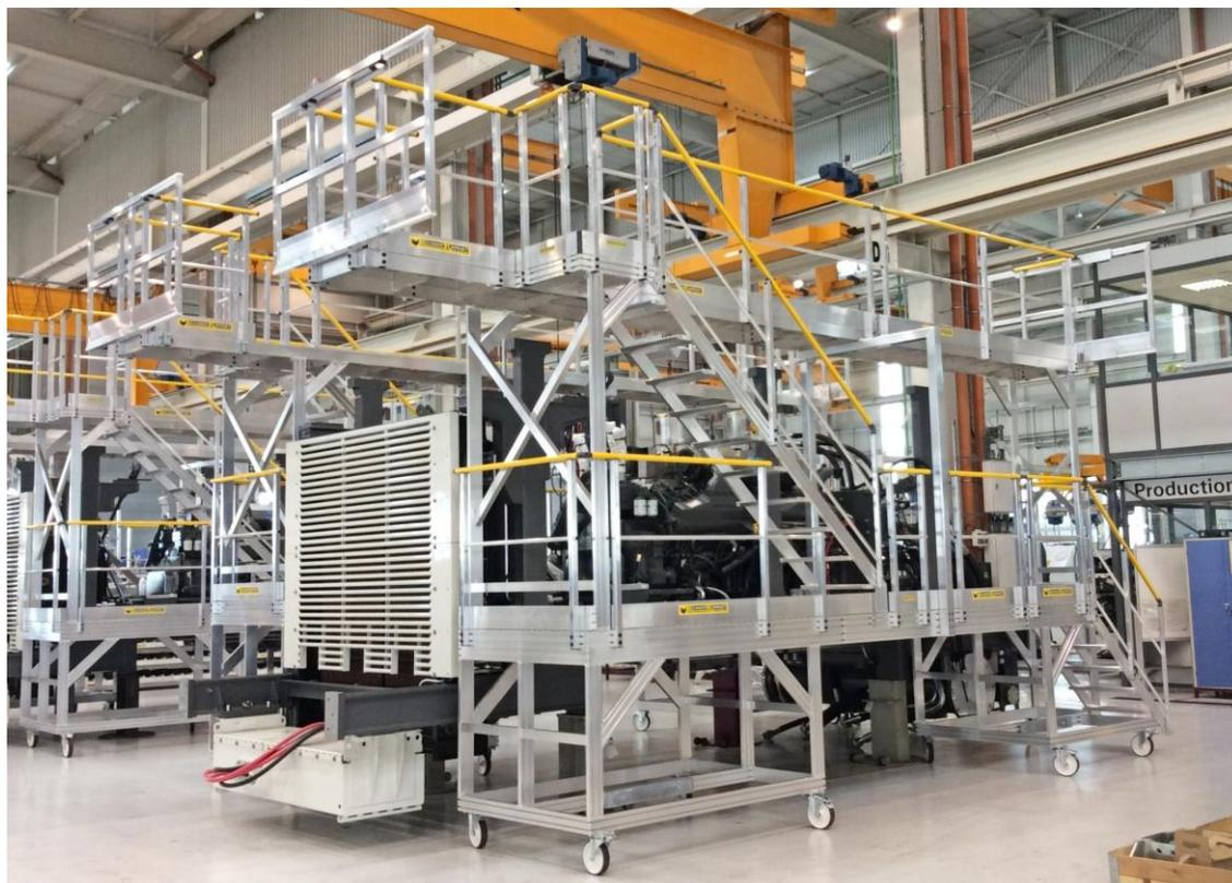
Zweistöckige mobile Plattform für den Motorzugang von Baumaschinen.
