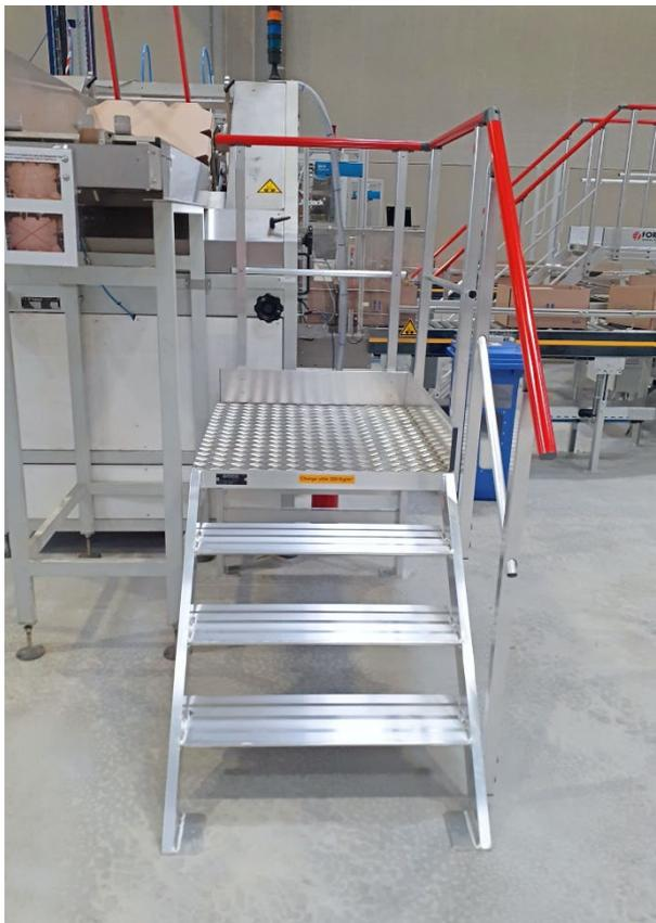
Arbeitsbühne aus stranggepresstem Aluminiumprofil 100x30 mm.
