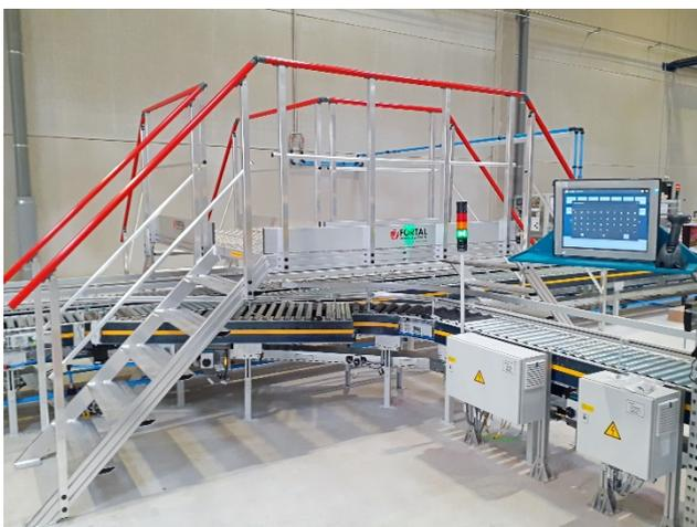
Dreifach-Zugangstreppe zum Überqueren von Förderbändern aus stranggepresstem Aluminiumprofil 100x30 mm.
