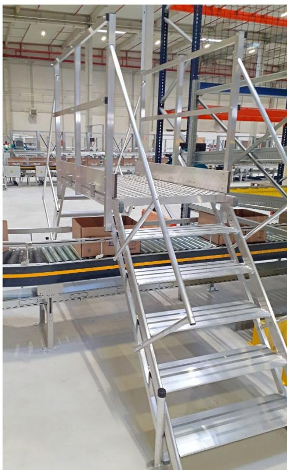
Doppelte Treppen mit gleichem Zugang aus stranggepresstem Aluminiumprofil 100 x 30 mm, hergestellt aus standardisierten Modulen der CLASSIC FORTAL-Reihe.
