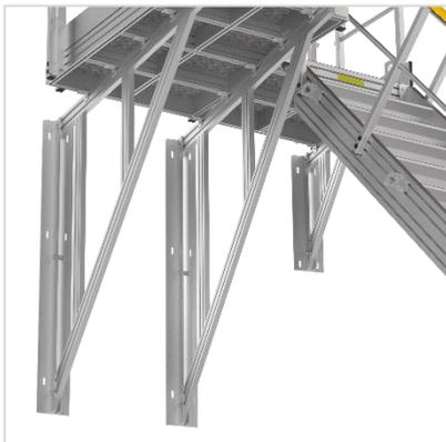
Das Podest ruht auf verstellbaren Aluminiumkonsolen, um sich an die Oberfläche der tragenden Wand anzupassen. In diesem Fall ist die Wand gekrümmt.
