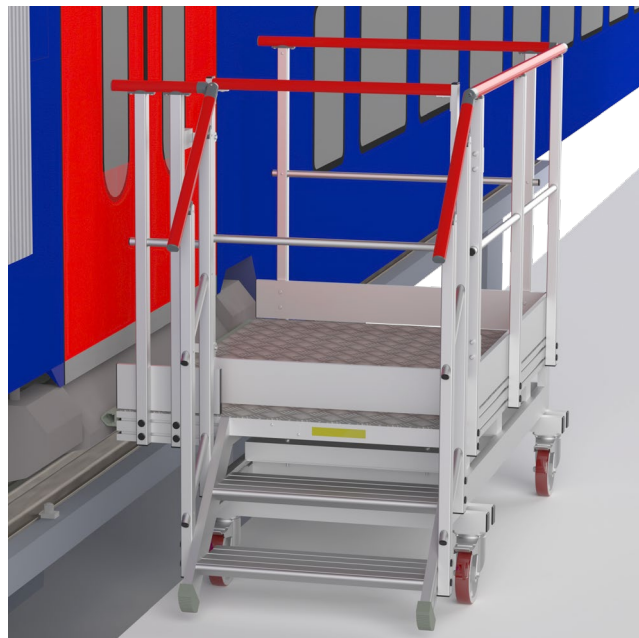
3D-Ansicht der mobilen Türzugangsplattform
