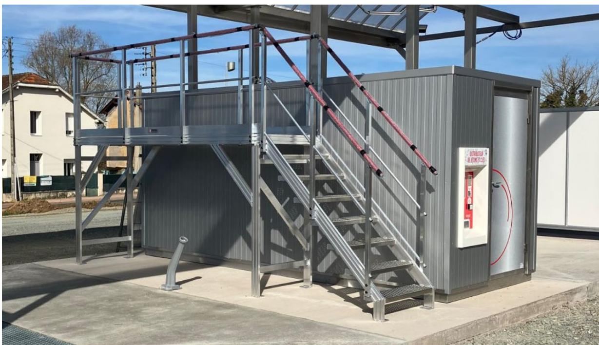
Einfacher, feststehender Laufsteg, der das sichere Waschen von großen Fahrzeugen ermöglicht. Hergestellt aus stranggepressten Aluminiumprofilen, die eine hohe Widerstandsfähigkeit gegen klimatische Einflüsse garantieren und keine Wartung erfordern. Die Verwendung von Gitterrosten für die Stufen und die Plattform gewährleistet, dass Flüssigkeiten gut ablaufen können.
